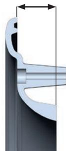
Les oculus CTI sont montés par pincement : la pièce extérieure dispose de plots avec taraudages, les plots de la pièce intérieure sont percés et lamés.
