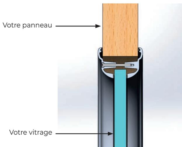
Le déport correspond à la profondeur entre la face en contact avec votre panneau et la face en contact avec le verre :
